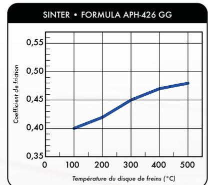
Coefficient de friction réduit par rapport aux plaquettes SF, permettant un contrôle maximal.
